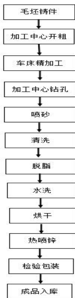
图 2.6-2 机械零部件生产工艺流程图
